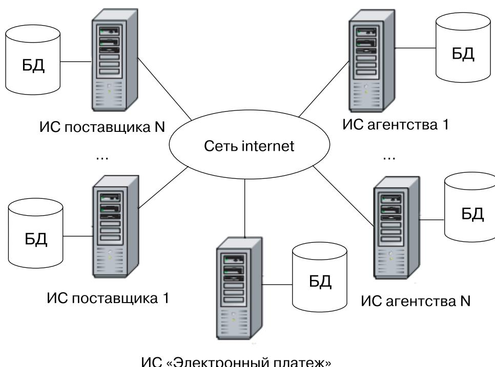
Рис. 2. Состав модулей для обмена данными в системе «Электронный платеж»
