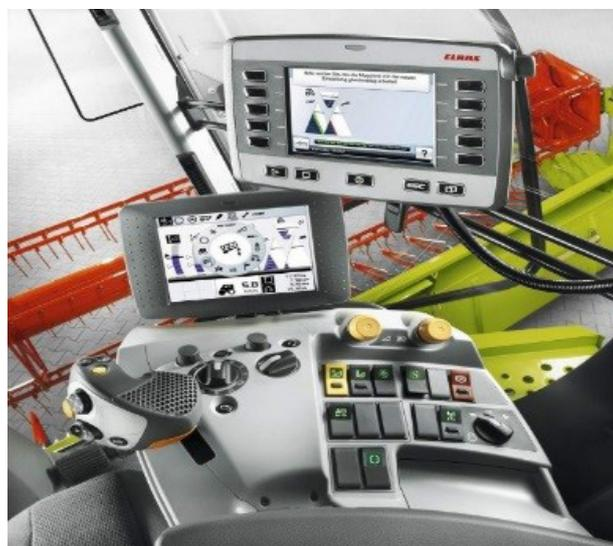
Рис. 16. Бортовая информационная система CEVIS с интегрированными в нее элементами интеллектуальной системы управления на основе гибридного вычислительного интеллекта
